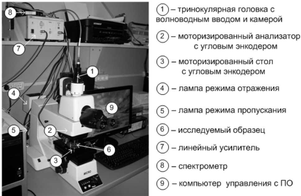
Рис. 1. Автоматизированная установка для одновременного измерения азимутальной и полярной энергии сцепления ЖК в одной твист нематической ячейке
